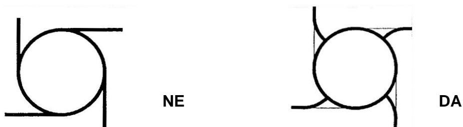
Slika 6: Vodenje krakov v krožišče: levo – nepravilno, desno – pravilno (Vir: TSC 03.341 : 2002)
