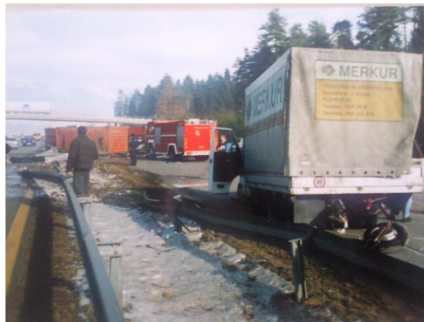
Slika 39: Primer trčenja tovornega vozila v kovinsko zaščitno ograjo in preboj na nasprotno smerno vozišče avtoceste
