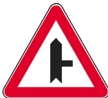
Slika 1: Stranska cesta, ki pripelje na glavno cesto z desne strani pod pravim kotom I-28.1
