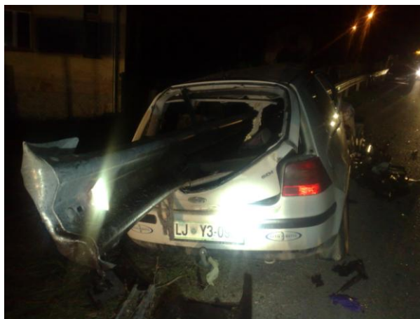
Slika 32: Posledice prometne nesreče brez naletne zaključnice
