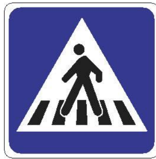
Slika 8: Prehod za pešce III-6
