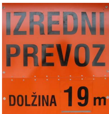
Slika 16: Znak na vozilu, ki prevaža izredni tovor, in podatek o dolžini vozila skupaj s tovorom
