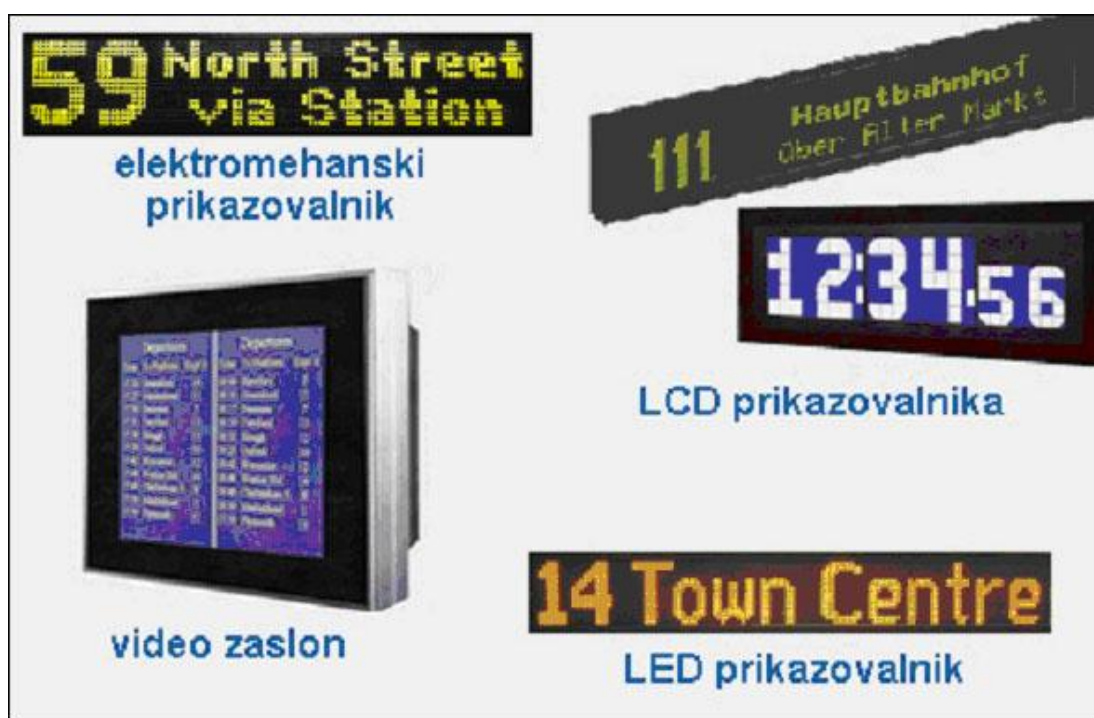
Slika 13: Različne tehnologije dinamičnih prikazovalnikov informacij
