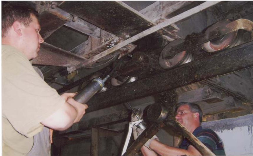
Slika 6: Podmazovanje koles vozička
