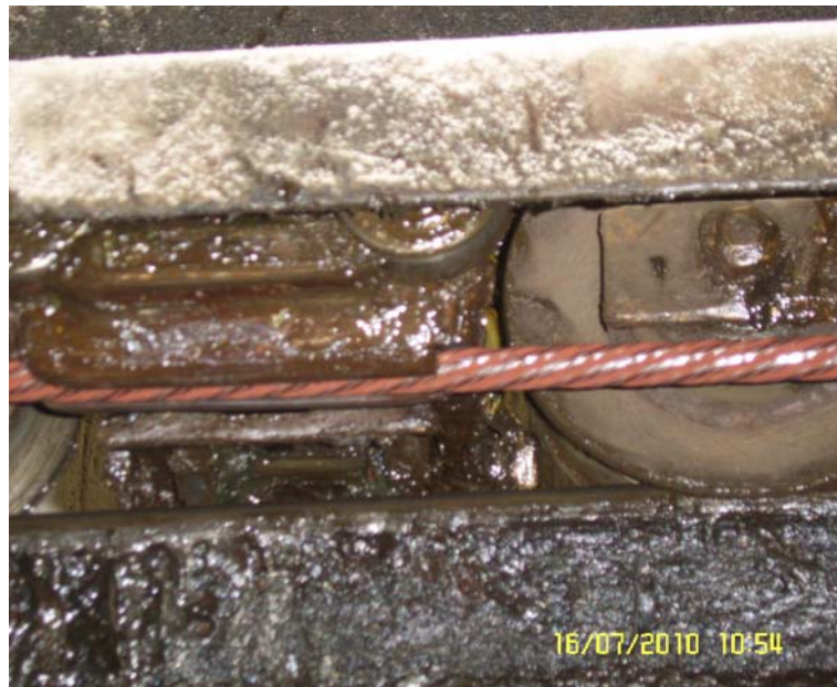
Slika 15: Prikaz čeljusti v trenutku, ko se voziček odklopi iz vrvi; posebna čeljust zagradi vrv
