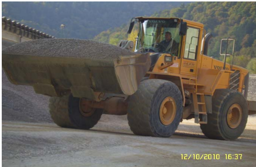
Slika 19: Nalaganje peska – drobljenca z nakladalcem
