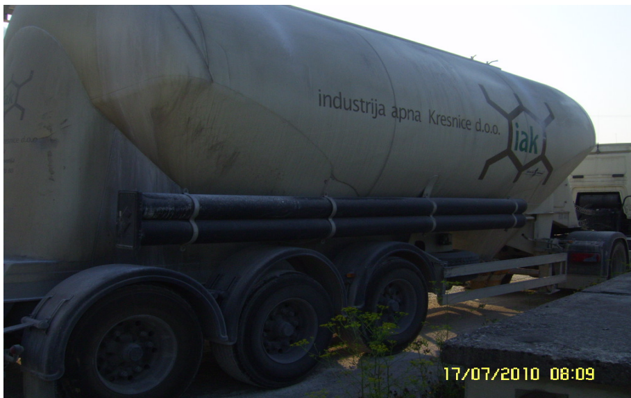
Slika 17: Cisterna za dostavo sipkega apna kupcem
