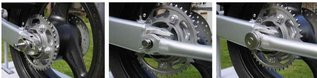
Slika 16: Prikaz priklopa prikolice na os zadnjega kolesa motorja ( Vir: Mono Trail Velika Britanija-internet )
