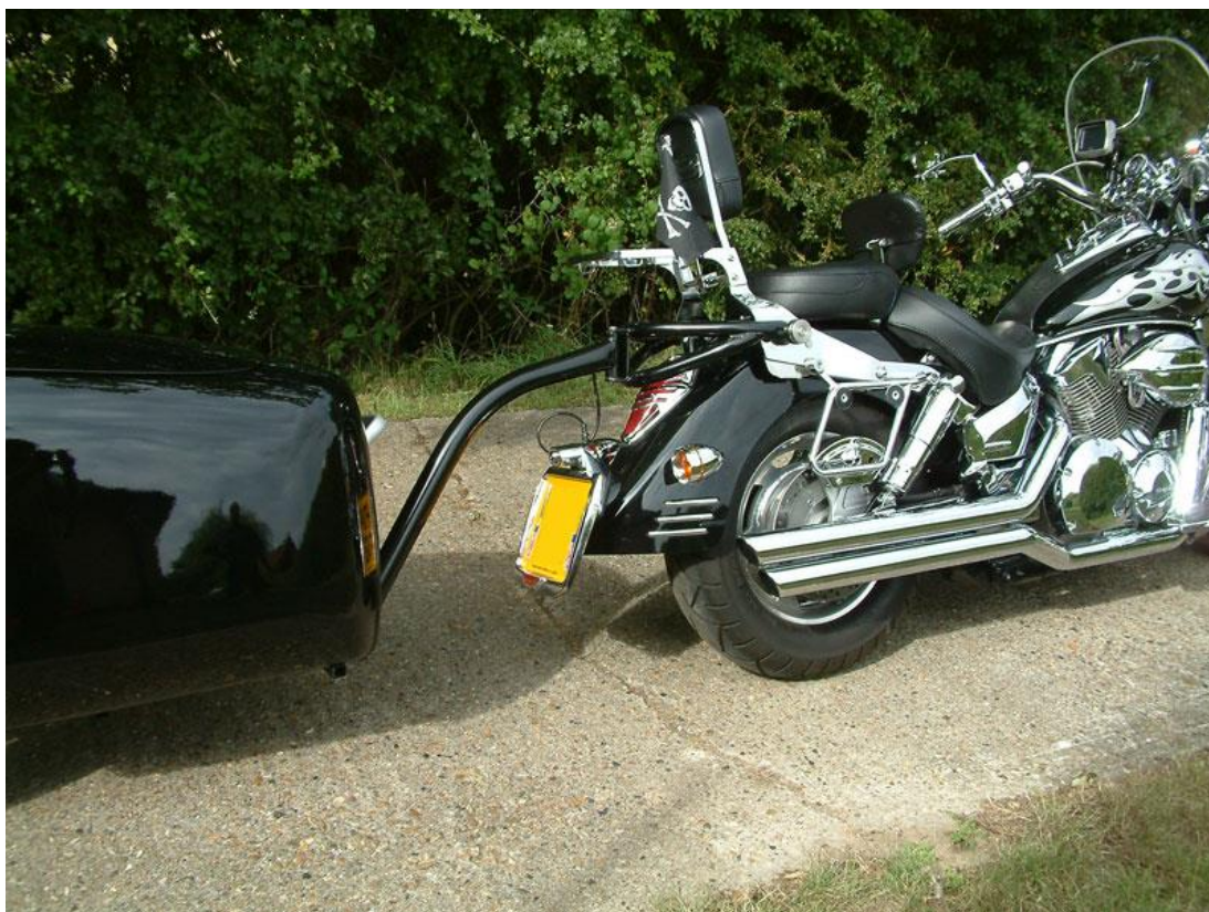
Slika 4: Priklop na nosilec naslona na zadnjem sedežu motorja (Vir: Podjetje Mono-Trail Velika Britanija )
