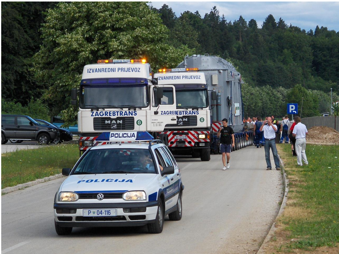
Slika 5: Primer policijskega spremstva – primer prevoza transformatorja na ciljno mesto transformatorske postaje v Naklem. Rezervno vlečno vozilo se uporabi v primeru morebitne okvare prvega vlečnega vozila in pomaga pri potiskanju kompozicije na večjih klančinah.
