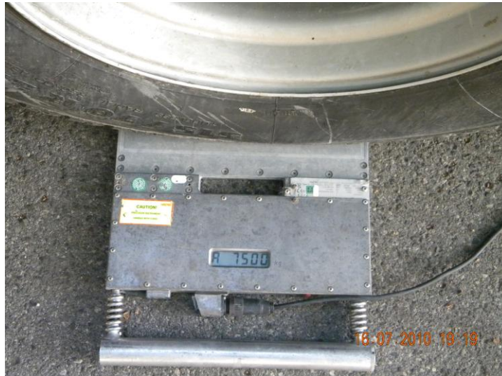
Sliki 3 in 4: Kontrolni pregled pred pričetkom izvajanja izrednega prevoza. Spodnja fotografija prikazuje rezultat meritve osne obremenitve ene izmed osi.
