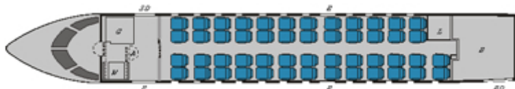
Slika 4: Različica letala CRJ200 z manjšim kuhinjskim prostorom, večjim prtljažnim prostorom in petdesetimi sedeži na krovu
