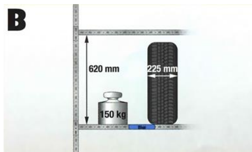
Slika 23: Označevalna tablica za gume velikosti do 225 mm in razmik med nosilci gum višine do 620 mm
