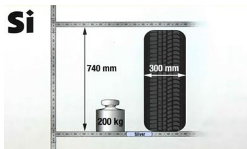
Slika 21: Označevalna tablica za gume velikosti do 300 mm in razmik med nosilci gum višine do 740 mm
