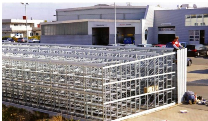
Slika 30: Regalni sestav se zapira s paneli (Vir: Katalog Automotive 2012)
