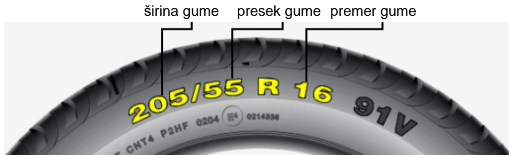
Slika 11: Oznake na pnevmatiki (Vir: http://www.avto.net/_OPREMA/pnevmatike.asp )
