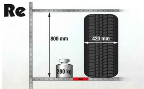
Slika 22: Označevalna tablica za gume velikosti do 420 mm in razmik med nosilci gum višine do 800 mm
