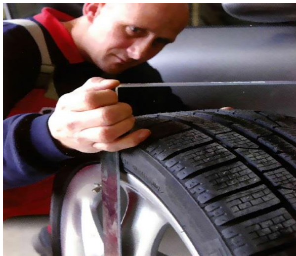
Slika 18: Kotni označevalec za določitev velikosti gume (Vir: Katalog Automotive 2012)
