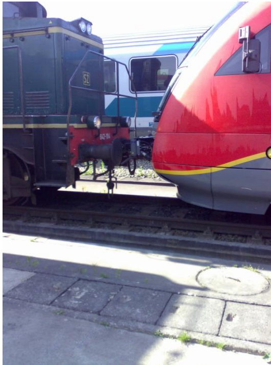
Slika 20: PREMIKALNA LOKOMOTIVA PREMIKA ELEKTROMOTORNE GARNITURE PO PRALNI PLOŠČADI
