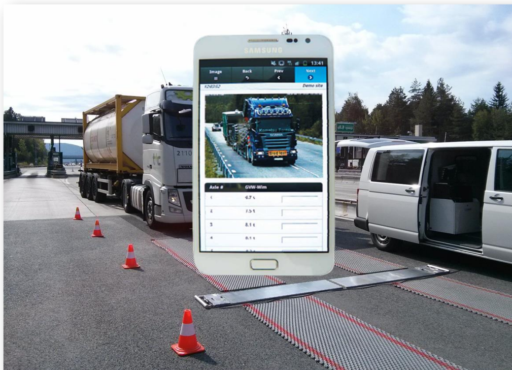
Slika 7: Tehtanje s pomočjo aplikacije SiWIM (Vir: Cestel d.o.o.)
