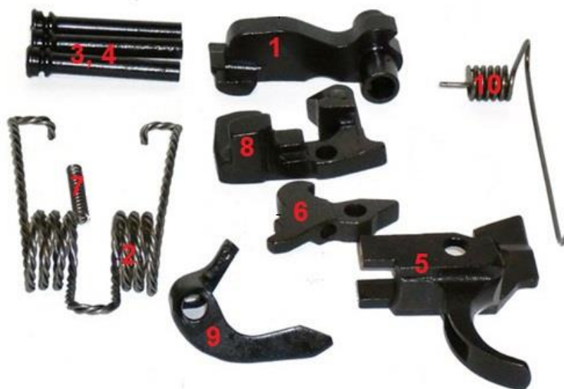
Slika 15: Sestavni deli sprožilnega mehanizma pušk tipa AK (Vir: Quora, 2018)
