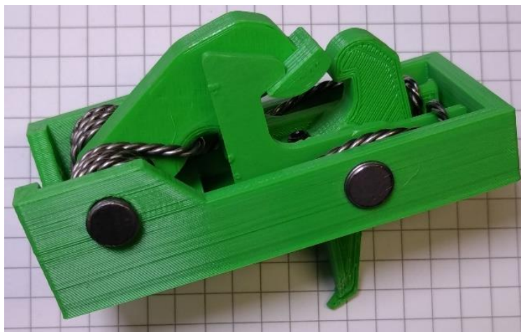
Slika 37: Sprožilni mehanizem v imitaciji zaklepišča (Lastni vir)
